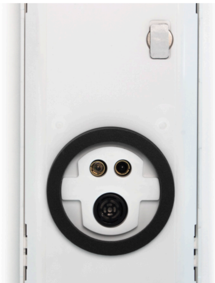
Die Unterseite des GT 1210 mit integriertem Ladesensor und Manipulationsanzeige.
